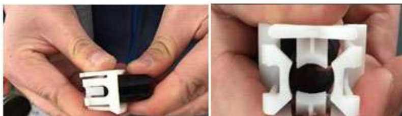
รูปที่ 7. แสดงการติดตั้งสวิตช์ไฟเบรก
