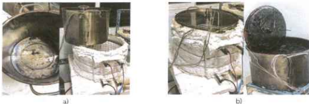
รูปที่ 4 องค์ประกอบของเตาทอรีแฟคชัน a) ตัวเตา ฉนวนหุ้มและตัวทำความร้อน b) การประกอบใช้งาน
