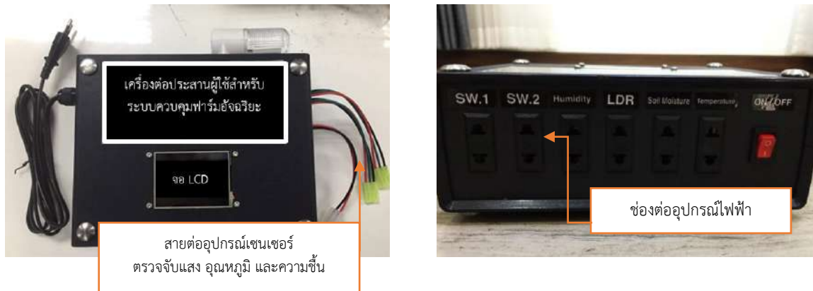
รูปที่ 4 เครื่องต่อประสานผู้ใช้สำหรับระบบควบคุมฟาร์มอัจฉริยะที่พัฒนาขึ้น
