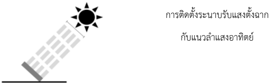
ภาพที่ 27 การติดตั้งเซลล์แสงอาทิตย์ในมุมเอียงที่แตกต่างกัน (1)
