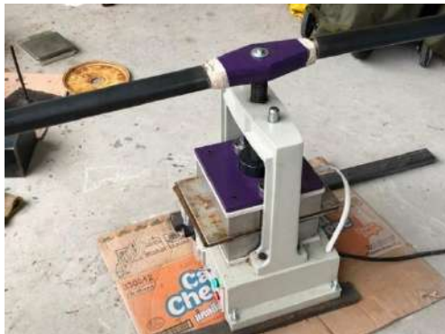
ภาพที่ 4 ท่อนเหล็กช่วยผ่อนแรงความยาว 1 เมตร สำหรับเครื่องอัดขึ้นรูปแบบใช้มือหมุน
