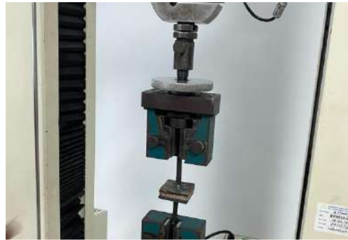
ภาพที่ 10 การทดสอบความต้านทานแรงดึงตั้งฉากกับผิวหน้าของแผ่นขึ้นไม้อัดจากเศษกิ่งไม้ต้นมะยงชิด
