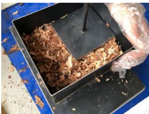
ภาพที่ 7 การบดอัดส่วนผสมเบื้องต้นให้แน่นอยู่ในแบบหล่อด้วยเหล็กกระทง
