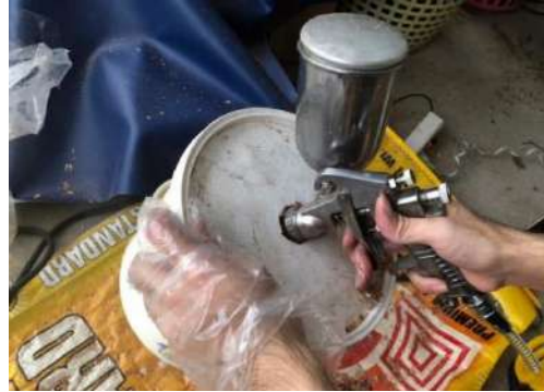
ภาพที่ 6 การฉีกพ่นกาวไดโอสไฮซานตลงในเศษไม้
