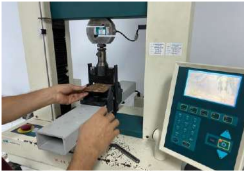
ภาพที่ 9 การทดสอบความต้านทานแรงดัดของแผ่นขึ้นไม้อัดจากเศษกิ่งไม้ต้นมะยงชิด
