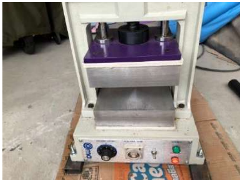
ภาพที่ 3 เครื่องขึ้นรูปแผ่นขึ้นไม้อัดด้วยความร้อน ชนิดอัตรารอบแบบใช้มือหมุน
