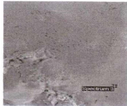
ภาพที่ 10 ภาพขยายเศษเซรามิกจากกล้องจุลทรรศน์อิเล็กตรอนแบบส่องกราด
