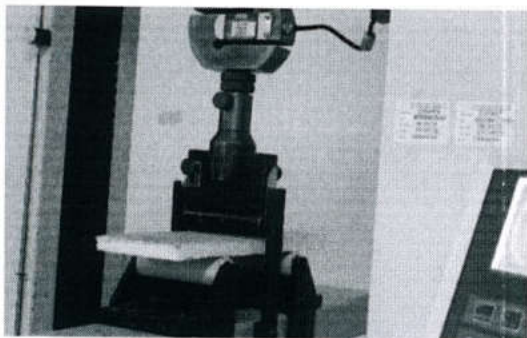
รูปที่ 6 การทดสอบแรงกดแตกของแผ่นยิปซัม
