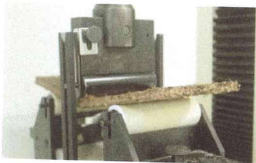
รูปที่ 6 การทดสอบความต้านทานแรงคัดของแผ่นขึ้นไม้อัด
