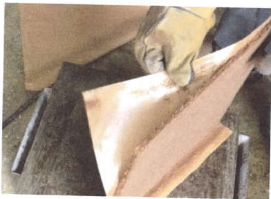
รูปที่ 5 นำแผ่นเทพล่อนออกจากแผ่นขึ้นไม้อัดที่ขึ้นรูป
