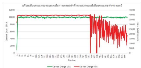
รูปที่ 11 กระแสไฟฟ้าของเซลล์แบตเตอรี่ขณะชาร์จที่ 0.25C และ 0.9C
