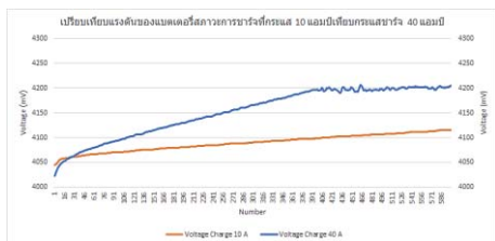
รูปที่ 10 แรงดันไฟฟ้าของเซลล์แบตเตอรี่ที่การชาร์จ 0.25C และ 0.9C
