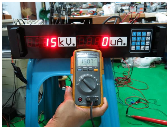
ภาพที่ 10 การทดสอบวงจรจ่ายแรงดันไฟฟ้ากระแสตรง แรงดันสูงที่แรงดัน 15 kV
