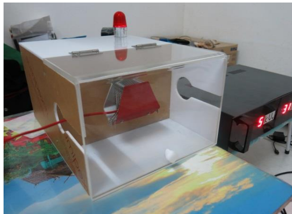
ภาพที่ 9 ภาพวิธีการทดสอบสายไฟชนิด THW
