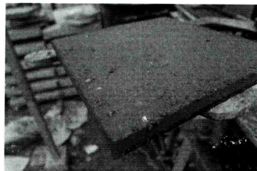
ภาพที่ 4 แผ่นใยอัดซีเมนต์จากเส้นใยฝักตบขวา
