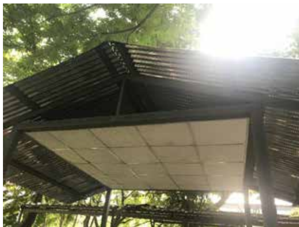
รูปที่ 14 การทดสอบการใช้งานจริงของแผ่นฝ้าเพดานขุยมะพร้าวผสมน้ำยางธรรมชาติ อัตราส่วน R0.03
