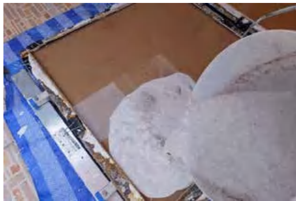
รูปที่ 4 การเทส่วนผสมผ้าเพดานลงในแบบหล่อ
