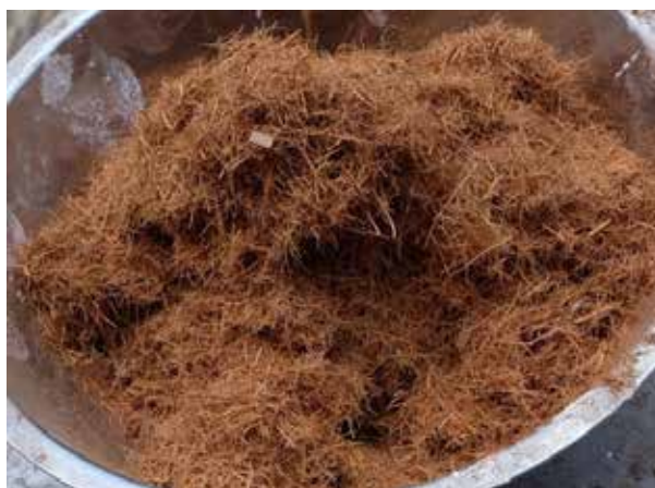
รูปที่ 1 ขุยมะพร้าวที่ผ่านตะแกรงเบอร์ 4 หรือ 4.72 มิลลิเมตร
