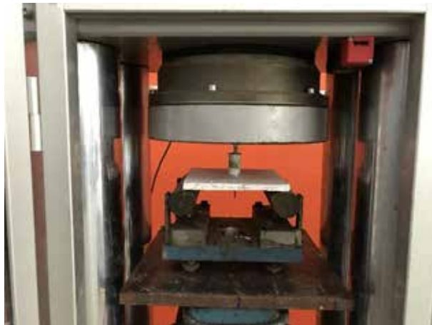
รูปที่ 5 การทดสอบแรงต้านทานการดึงตะปูของแผ่นผ้าเพดานชুমะพร้าว
