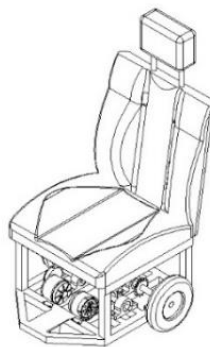
รูปที่ 1 โครงสร้างการออกแบบรถเข็นผู้ป่วยสำหรับการควบคุมระยะไกล
