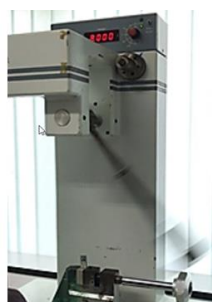
ภาพที่ 11 การจับชิ้นงานเข้ากับเครื่องทดสอบแรงกระแทก
