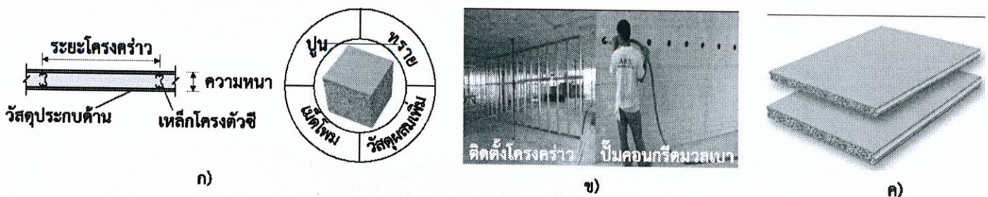
ภาพที่ 4 ระบบผนังแบบ Infill Wall (ก) วัสดุที่ใช้ในระบบผนัง (ข) ตัวอย่างการติดตั้งหน้างาน และ (ค) ระบบผนัง Infill Wall แบบสำเร็จรูป [5]
