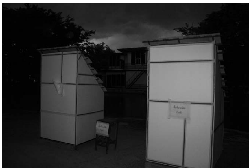
รูปที่ 4.12 อาคารจำลองที่ผนังด้านในมีการติดตั้งแผ่นใยชีวภาพอัดความหนาแน่นปานกลางที่ผสมเส้นใยอัตราส่วน CC50 และแผ่นฉนวนใยหินอัดชนิดอัดราบทั่วไป
